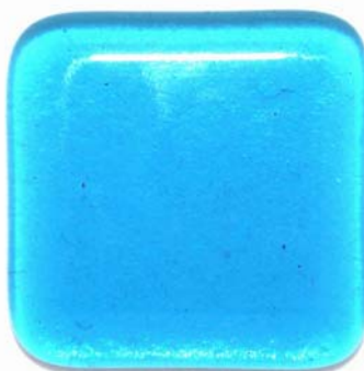
2 lag, totalt 6 mm Ingen tap av form, fin avrundede kanter
