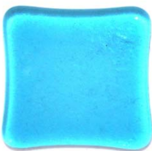
1 lag, totalt 3 mm Glasset ble trukket innover
